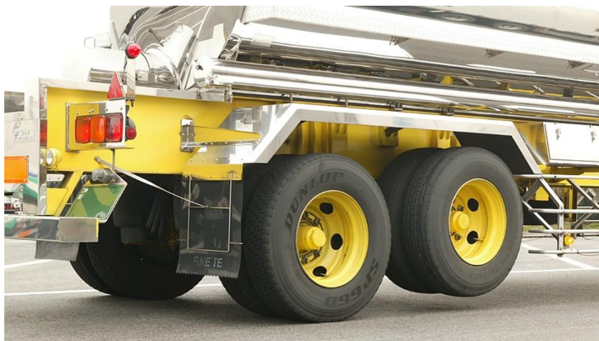
Figure 39: Picture of a lifted axle if HDV is driving with low weight (image from https://de.wikipedia.org/wiki/Liftachse#/media/Datei:Airlift_axle_002.JPG ).
